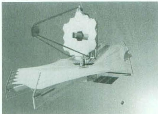
図2 日除パネル, 太陽電池パネル, 望遠鏡を展開した JWST の予想図.
